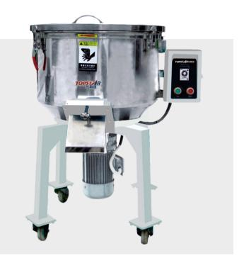
多片立式桨叶,产生涡流全方位混合,混合力强,短时间内完成均匀混料,低耗能,高效率。采用进口垂直减速马达,低噪音及持久耐用。占地面积少,脚轮装置移动方便。
