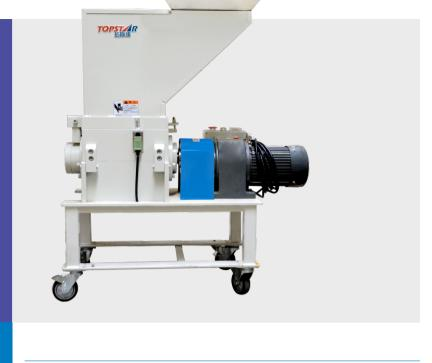
属于无筛网型塑胶回收粉碎机。 20~28 rpm低速运转,齿啃式刀具设计,专门设计用于粉碎各类硬性及易脆塑胶之不良产品,次品的机边粉碎回收利用; 尤其适合粉碎回收PC、尼龙、ABS等硬质水口料。具有转速低,扭矩大,噪音低,产生粉尘少,操作简便的优点,而且具备产品粉碎颗粒均匀,粉碎效果极佳,设备运转中无过热现象,使用寿命长等特点。
