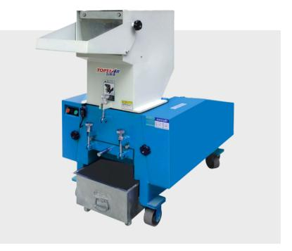
特别适用于各类硬性塑胶之粉碎再利用,效果更佳。刀架优化设计,又分为片刀型,爪刀型和平刀型。爪型刀可分散受力度,使得每片刀的剪切加大,尤其适合厚件产品及大块胶头,硬质料块等,有效的提高了刀具切削力、减少刀具磨损。设有电控安全设计,多项安全保护装置,确保操作安全。
